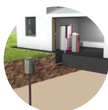
Geotermica sonda a CO2
